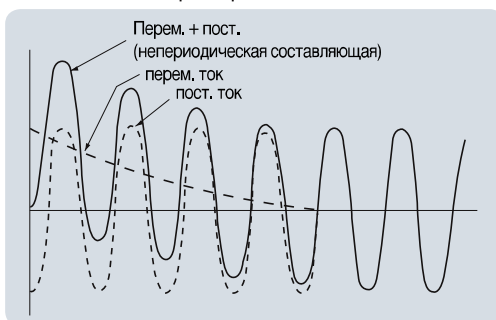
Рис. 1 Составляющие тока короткого замыкания
